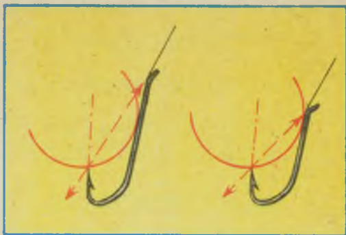
Рис. 5. Зацепистость крючков с длинным (слева) и коротким цевьем.
